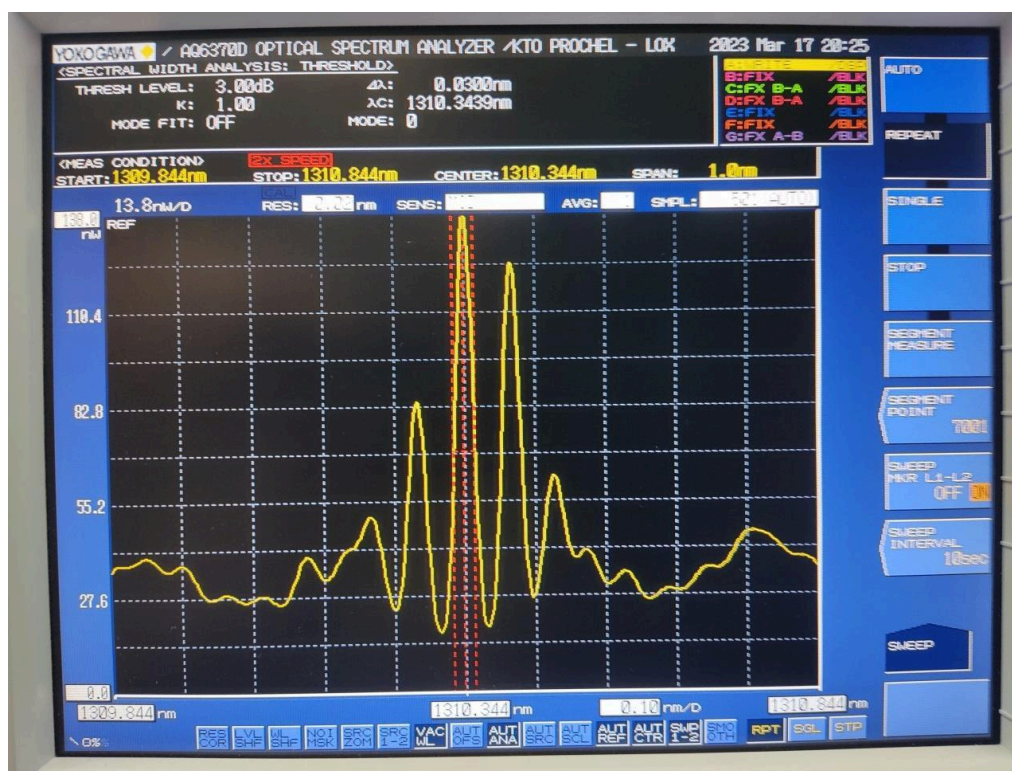
Рисунок 1.1.1.15. Спектр излучения лазерного диода BLD-1310-14BF при 25°C и токе 39,9 мА, развертка 0,1 нм/дел.
